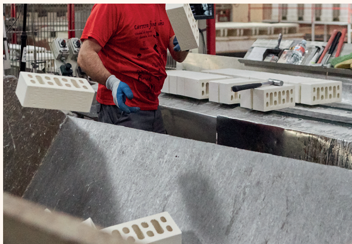
Figura 8. El reciclado se produce incluso en fábrica: el material sobrante en probetas y ensayos se incorpora como material de partida al comienzo de la producción.
