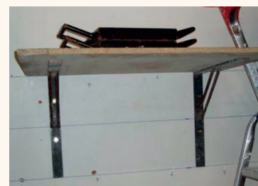
Figura 11. Ensayo de cargas verticales excéntricas sobre una pared cerámica de LHGF de 7 cm, sometido a la pared a la aplicación de forma continuada durante 24 h de una carga de 1000 N a 30 cm de la pared aplicada sobre una estantería
