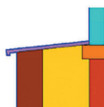
Figura 5: Puentes térmico lineal del encuentro de la fachada Estructura con la ventana
