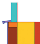
Figura 4: Puentes térmico lineal del encuentro de la fachada Estructura con el frente del forjado.
