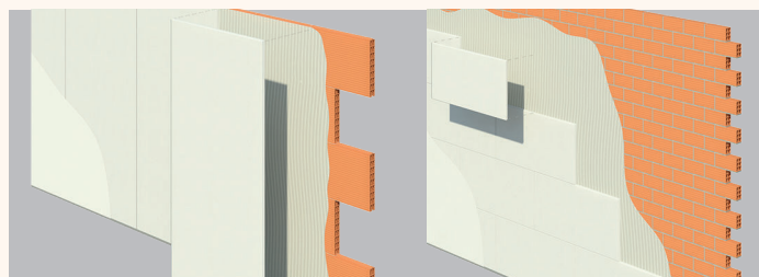
Figura 3. Tabiquerías de ladrillo hueco de pequeño formato con revestimiento
